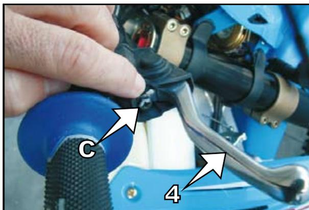
**FRONT BRAKE LEVER BREMBO RADIAL PUMP (SMR/SMM/SMX)**
